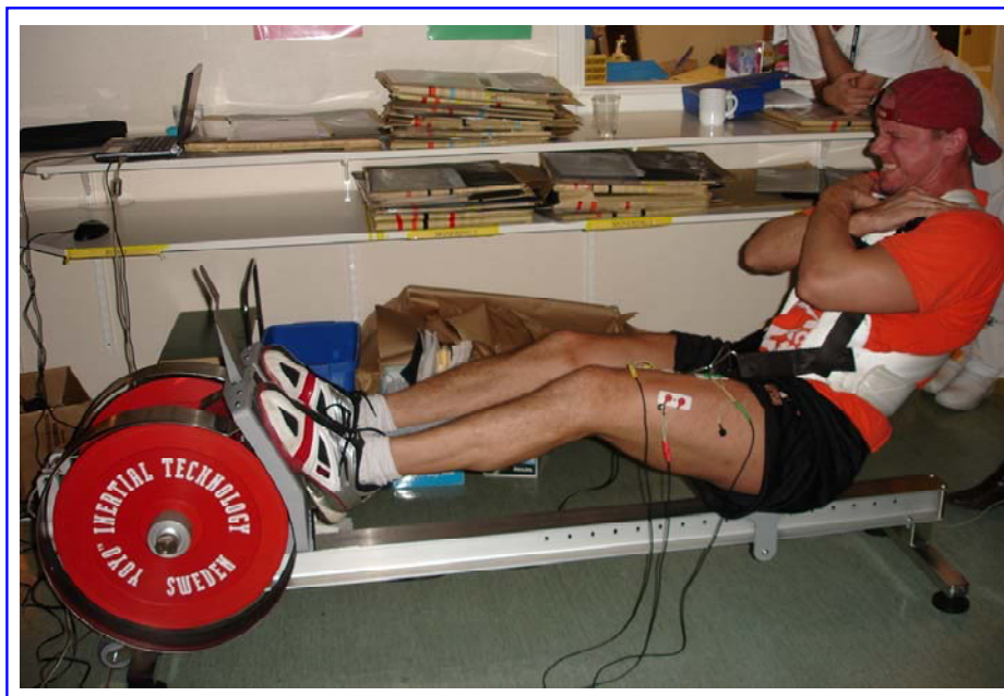
Figura 1. Un soggetto mentre esegue l'equivalente di un esercizio di squat sulla Flywheel Multigym. Il soggetto indossa un'imbracatura connessa, mediante una cinghia, all'asse del volano, che è posto in rotazione (azione concentrica, CON) quando egli spinge con le gambe contro le pedane, spingendosi all'indietro sul binario. La conseguente azione eccentrica (ECC) accoppiata consiste nel resistere alla forza di richiamo del volano dopo che la cinghia è stata completamente svolta ed inizia a riavvolgersi.
